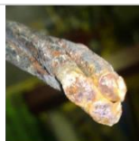
3-aderig koperen aardedraad doorsnede 3mm
