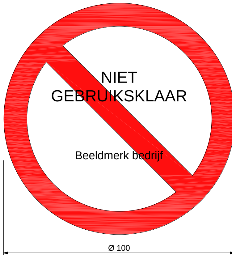
Figuur 4 uit NEN 2559:2001/Ontw.A5:2020 - Etiket dat aangeeft dat een blustoestel niet gebruiksklaar is
