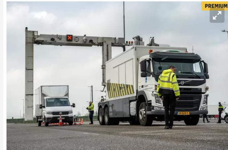
Met een van de douane in de haven van Vlissingen geleende scannerwagen werd op Hazeldonk maandag de lading van vrachtwagens doorgelicht. © Pix4Profs-Ron Magleise
